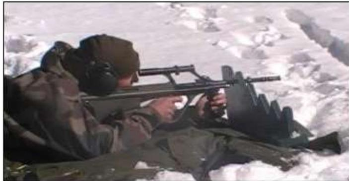
Al igual que el calibre 7,62mm, el de 5,56 mm tenía el mismo comportamiento, pero a diferencia del anterior éste tenía una menor penetración y se produjeron cambios en la trayectoria a 90 grados una vez que penetró el bloque de nieve.
