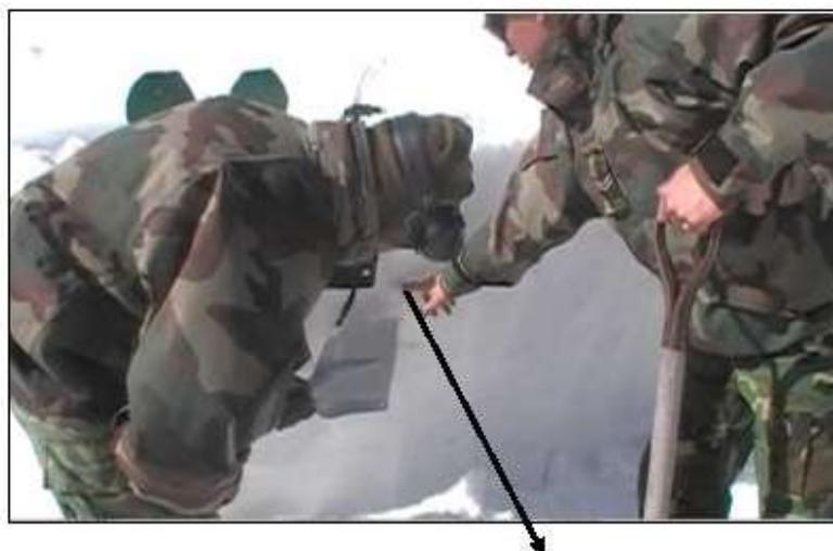
Penetración del calibre 9mm en el Bloque de Nieve
